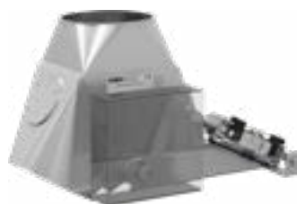
Beispiel: 2-Wege-Verteiler 60°, bis DN 300 mm symmetrisch, pneumatisch betätigt mit Hubzylinder
